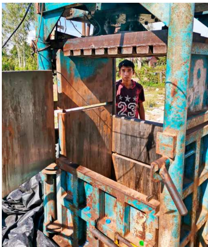
Dank einer einfachen Pressmaschine kann das gesammelte PET für das Recycling aufbereitet werden.
